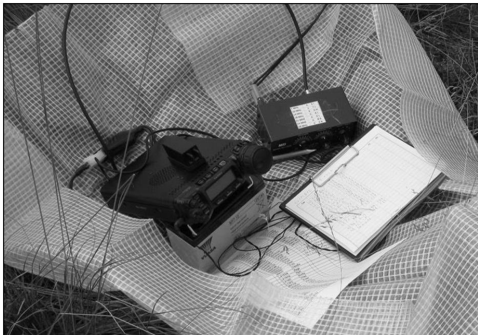
Zařízení na Medvědí hoře OK/PL-012: FT-857, ATU MFJ-902H, gelový akumulátor 12V/7,2Ah
