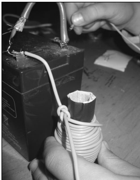
Elektromagnetické dělo střílí neodymové magnety až ke stropu.
