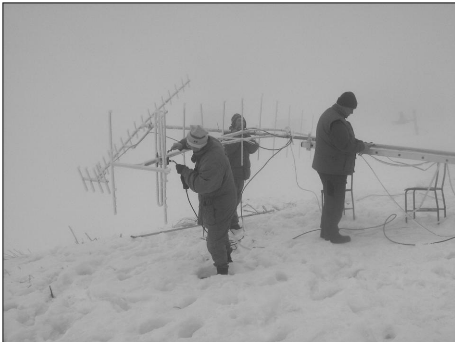
Námraza zdeformovala antény do nepoužitelná
