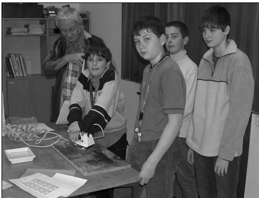
Žehlíme plošné spoje
