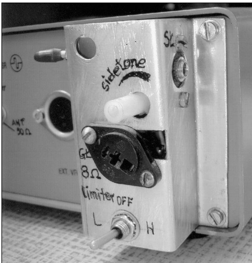
Pohled na umístění a montáž v zadní části zařízení: Přepínač repro/sluchátka, stereo jack 3,5 mm, potenciometr regulace hlasitosti příposlechu, konektor pro reproduktor, omezovač poruch L-Off-H
