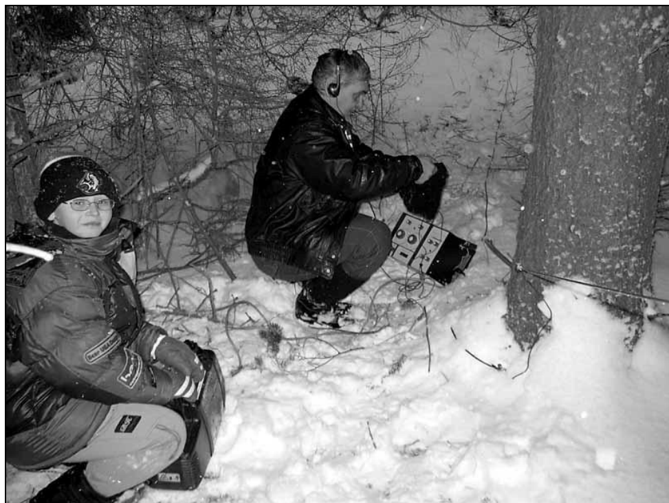
Pepa, OK1ANP měří v terénu impedanci antény beverage, jeho vnuk Pěťa dodává energii z elektrocentrály Pepa, OK1ANP is measuring the Beverage impedance, Peta is attending power generator
