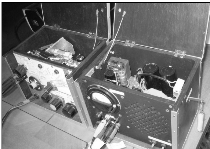
Přijímač se síťovým zdrojem a repro, vpravo speciální vypínač. Skříňky jsou z překližky, povrchová úprava mahagon. Snobismus, co? Hi.
