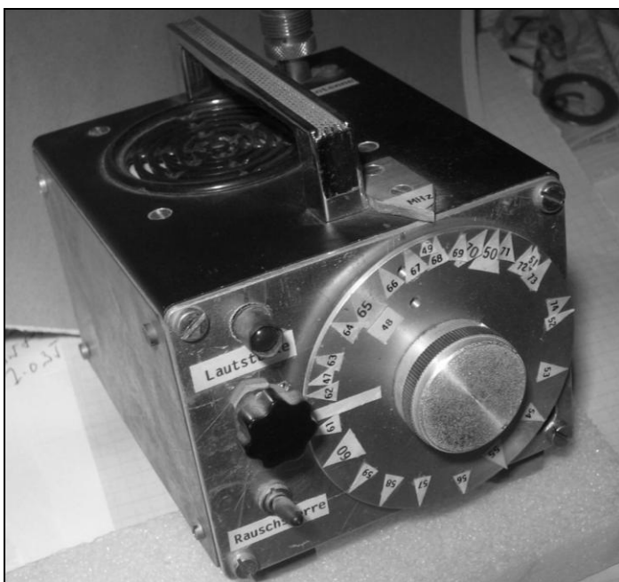
UKV přijímač, 47 - 74 MHz, pro sledování podmínek šíření na 50 MHz, FM rozhlasu a odposlech spojovací služby v QRL ...
