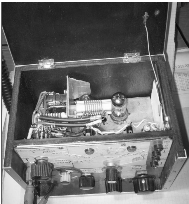
KV přijímač podle OK1JSI, osazení ECC85 + ECC83
