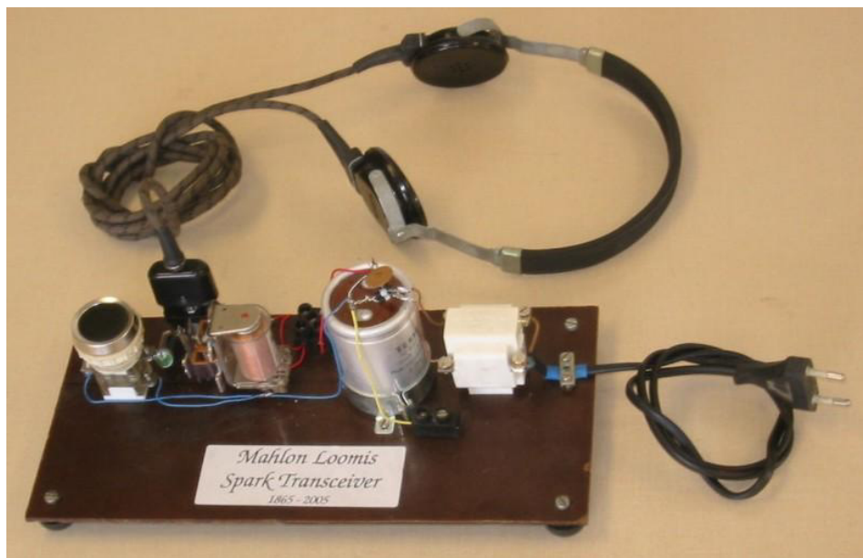
Jiskrový telegrafní transceiver JTT-11 na štítku je nápis "Mahlon Loomis, Spark Transceiver 1865-2005"
