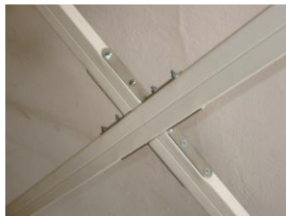
Detail konstrukce rámové antény. Ramena jsou z uzavřených elektroinstalačních lišt, sešroubovaných úhelníky
