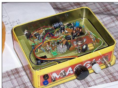
Do krabičky od polévek vmontoval svůj transceiver pro 80 m Milan OK2HWP
