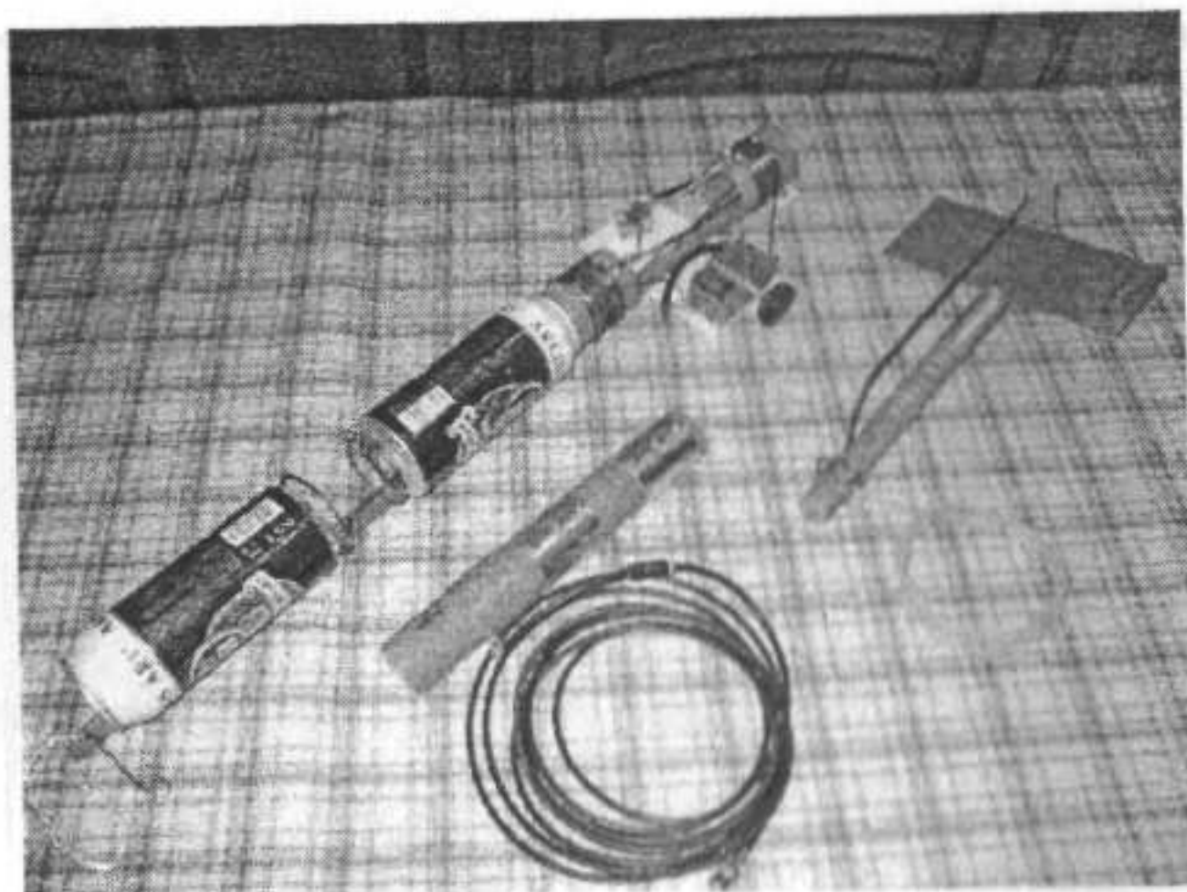
Vlevo je anténa EHA s napájecím obvodem L+L pro 7 MHz, zhotovil ji Milan OM3TBG. S touto anténou a s NorCal 20 předvedl Milan spojení s Eu stanicemi (rst 559 až 599) a DX spojení s UA9 (rcvd 559). Uprostřed jednoduchá EH, vpravo ISOTRON. Obě jsou pro 21 MHz, zhotovil je Igor OM3CUG. From left to right: EHA (7 MHz) by OM3TBG (reports 559 to 599 from EU, 559 from UA9, NorCal 20 used), simple EH and ISOTRON (21 MHz), OM3CUG made.
