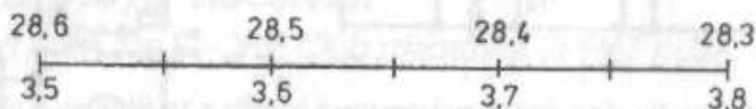
Monogram pro převod kmitočtů z 28 MHz na 3,5 MHz
